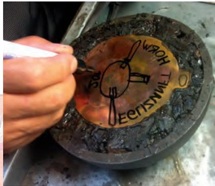
Diese Scheibe wird auf eine «Kittkugel» montiert. Durch erwärmen mit dem Bunsenbrenner wird der Kitt weich und somit haftet die Kupferscheibe darauf.
